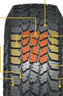
**VERTIKALE AUSBUCHTUNGEN IM BEREICH DES NEGATIVPROFILS**
