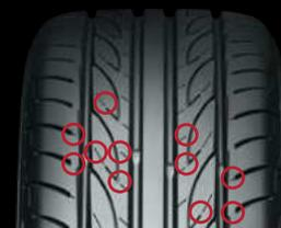
Nicht durchdringende Stollenrillen zielen darauf ab, Geräusche zu reduzieren. Die Blöcke erhöhen die Steifigkeit, um das direkte Handling zu verbessern und die Reibung zu reduzieren.
